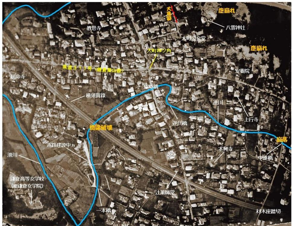
**亀裂崩壊**・県道名越踏切りより隧道まで約3丁（330m）の間亀裂を生じ、坂の両側は決壊し、隧道入口の崖崩落して、一時交通を遮断した。八雲神社より妙本寺総門に至る約三町の間および同門前十数間にわたり大亀裂を生じた。
